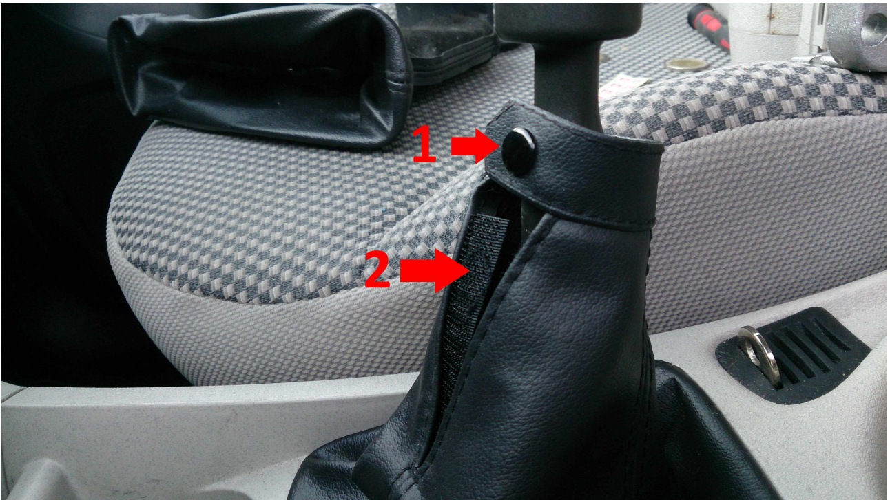
(Abb. 2) Den Druckknopf 1 öffnen. Den Klettverschluss 2 öffnen.
