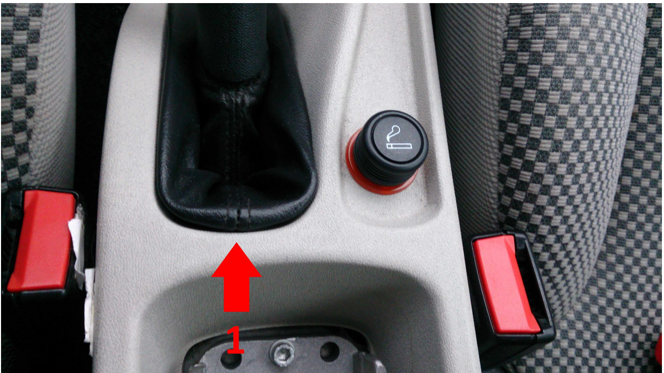
(Abb. 3) Mit dem Schraubendreher vorsichtig die obere Nase (1) aushebeln und den Sack der Feststellbremse nach vorn über den Bremshebel ziehen.
